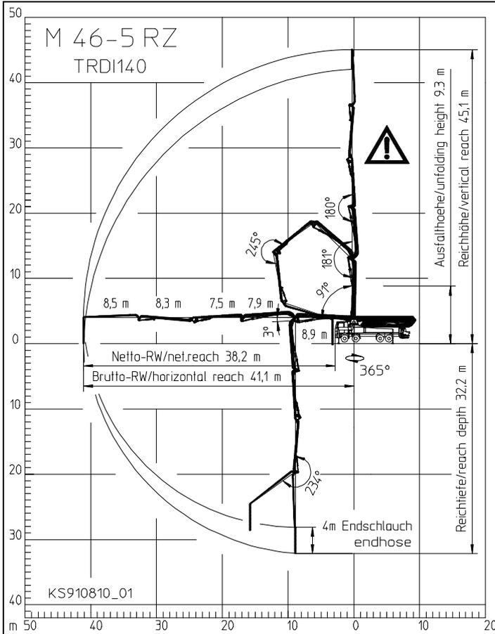
Bereich in dem mit dem Endschlauch nicht gearbeitet werden darf.
